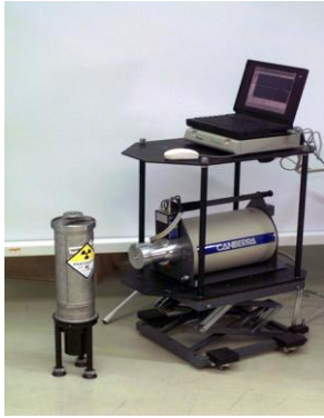
Figure 1 : chaîne de mesure de spectrométrie \gamma et exemple de spectre \gamma d'un échantillon d'uranium
